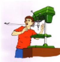
Bohrfutterschlüssel sofort nach dem Einspannen des Bohrers entfernen
