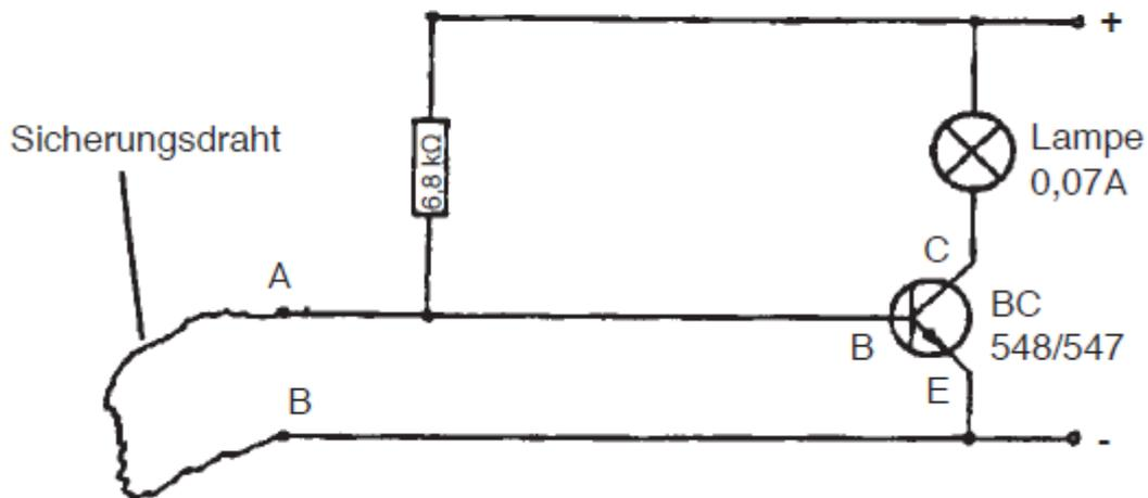
Ersetze den Sicherungsdraht durch einen Schalter!
